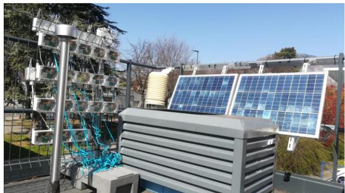
Figure 5 : Photo d'installation d'une intercomparaison de micro-capteurs sur une station fixe réglementaire du réseau d'Atmo Auvergne-Rhône-Alpes
