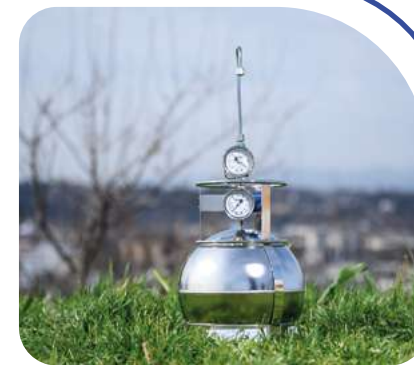
Canister de prélèvement d'échantillon d'air ambiant
