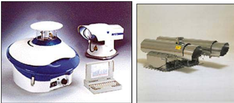
Figure 22 : exemples de DOAS (à gauche type SANOA et à droite type OPSIS)
