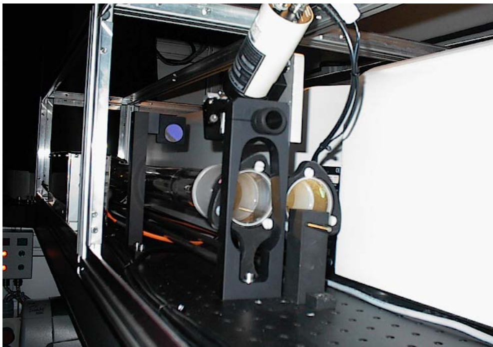
Figure 30: Nouvelles cellules de calibration (passage unique, montage en Barillet)
