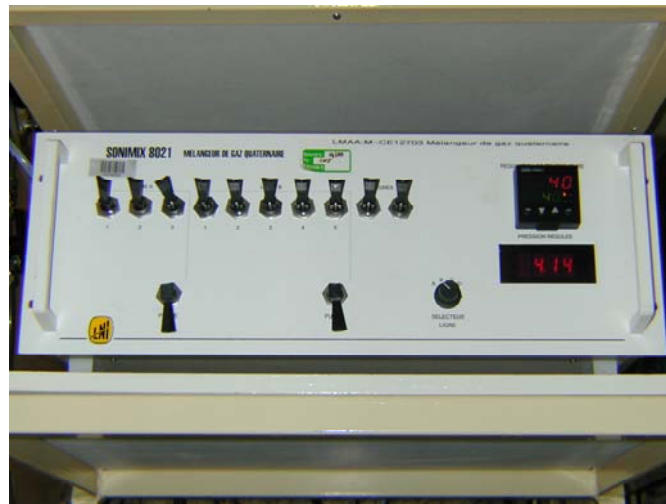
Figure 21: photographie du diluteur SONIMIX utilisé pour générer les concentrations de benzène et de toluène
