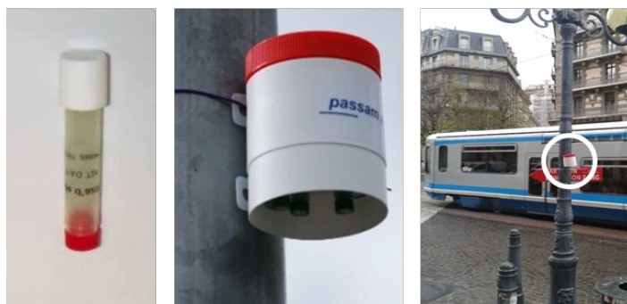
Echantillonneurs passifs pour le NO 2 . A gauche, un échantillonneur passif de marque PASSAM ; au milieu, des échantillonneurs passifs dans leur « boîtier » au cours d'une campagne de mesure ; à droite, un site de mesure équipé
