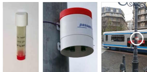
Echantillonneurs passifs pour le NO 2
