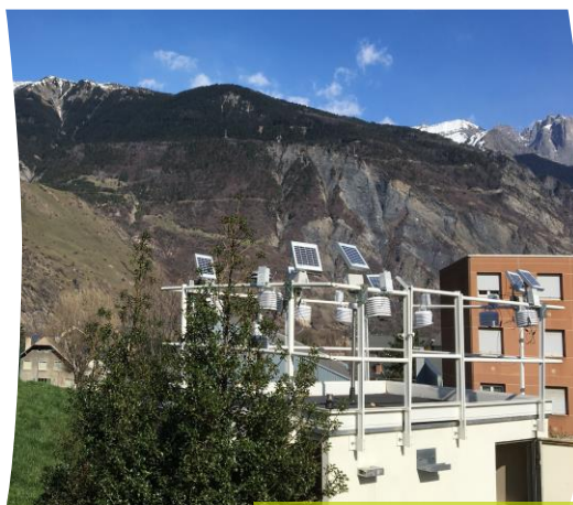
Microcapteurs en intercomparaison sur la station de St Jean de Maurienne
