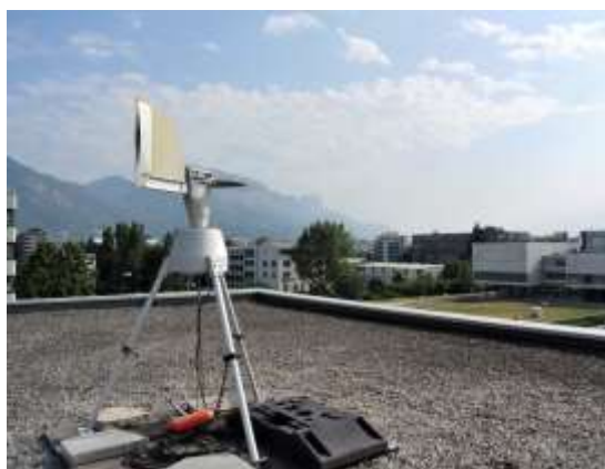
Capteur de pollens du site de Grenoble (44 avenue Marcellin Berthelot - GRENOBLE) Prélèvement à une hauteur de 20 m du sol
