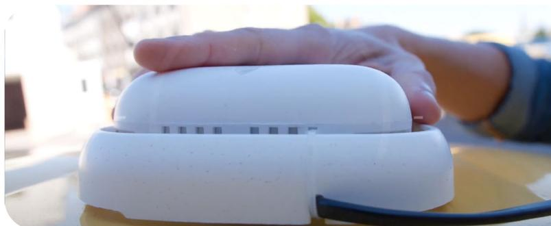
Des micro-capteurs Atmotrack déployés par Geoptis sur des véhicules du groupe La Poste pour récolter dynamiquement des données de qualité de l'air.
