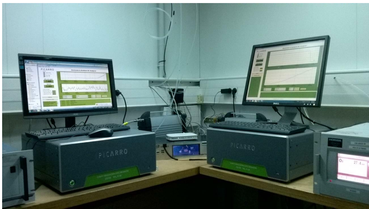
Figure 4 Appareil PICARRO en test dans une station de mesure d'ATMO Auvergne-Rhône-Alpes
