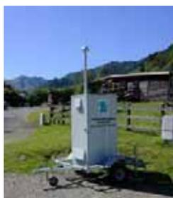
Cette cabine (1 m de longueur, 0,70 m de largeur et 1,70 m de hauteur) permet de mesurer 1 à 3 polluants simultanément.
