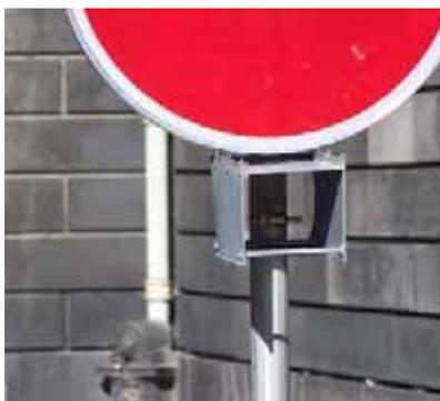
Surveillance du  $\text{NO}_2$  par échantillonneur passif
