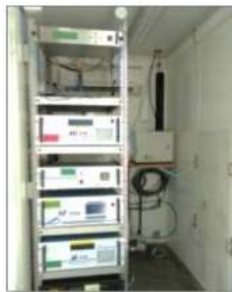
Mesures continues embarqués du laboratoire mobile (NOx, PM10)
