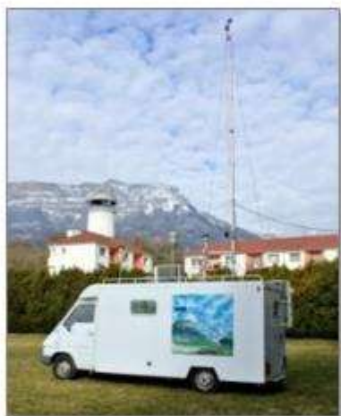
Laboratoire mobile et Mât météo (vitesse et direction du vent)
