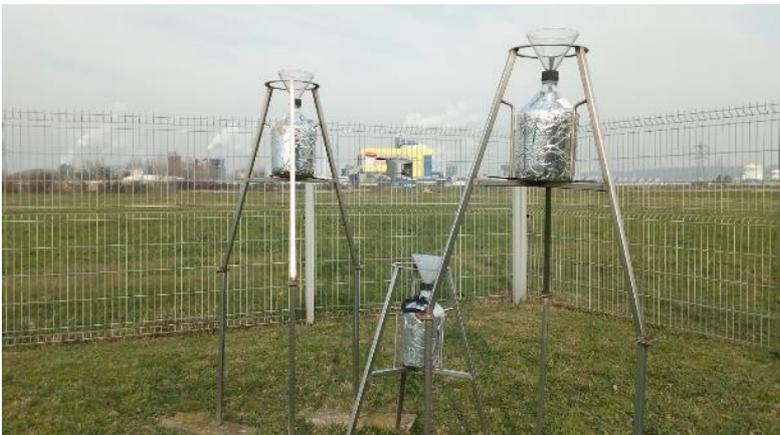
Figure 41 Jauges installées dans l'enceinte de la maison de projet
