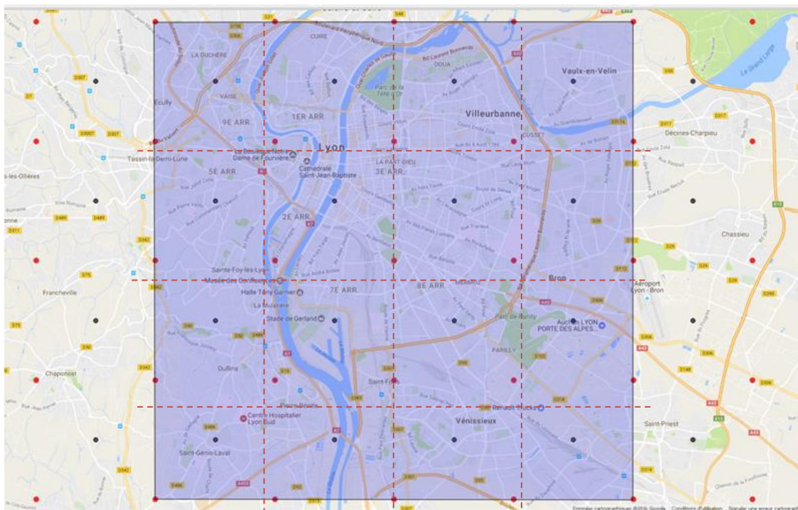
Figure 22 : Quadrillage de l'agglomération lyonnaise pour le déploiement des micro-capteurs
