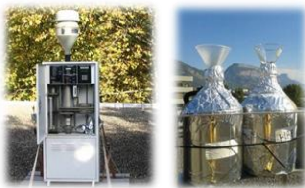
Figure 3 Matériel de mesures : digital DA 80 à gauche et jauges owen (à droite)
