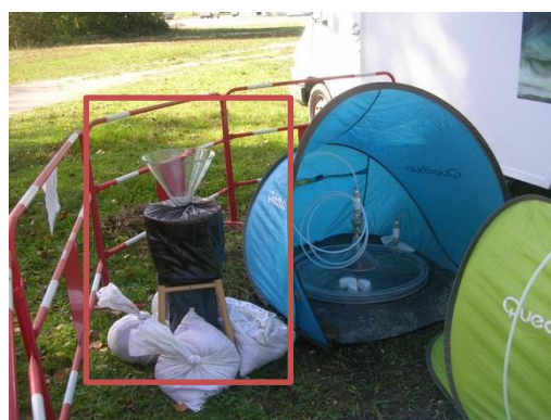
FIGURE 12 : JAUGE OWEN MISE EN PLACE SUR LE SITE EXPERIMENTAL. LE FLACON RECEPTEUR EST MIS A L'ABRI DE LA LUMIERE SOUS UNE BACHE NOIRE OPAQUE EMPECHANT TOUTE TRANSFORMATION PHOTOCHIMIQUE EN PHASE AQUEUSE
