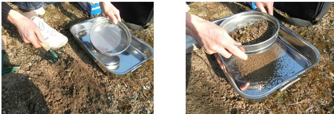
FIGURE 9 PRELEVEMENT ET TAMISAGE DU SOL SUR LE SITE EXPERIMENTAL
