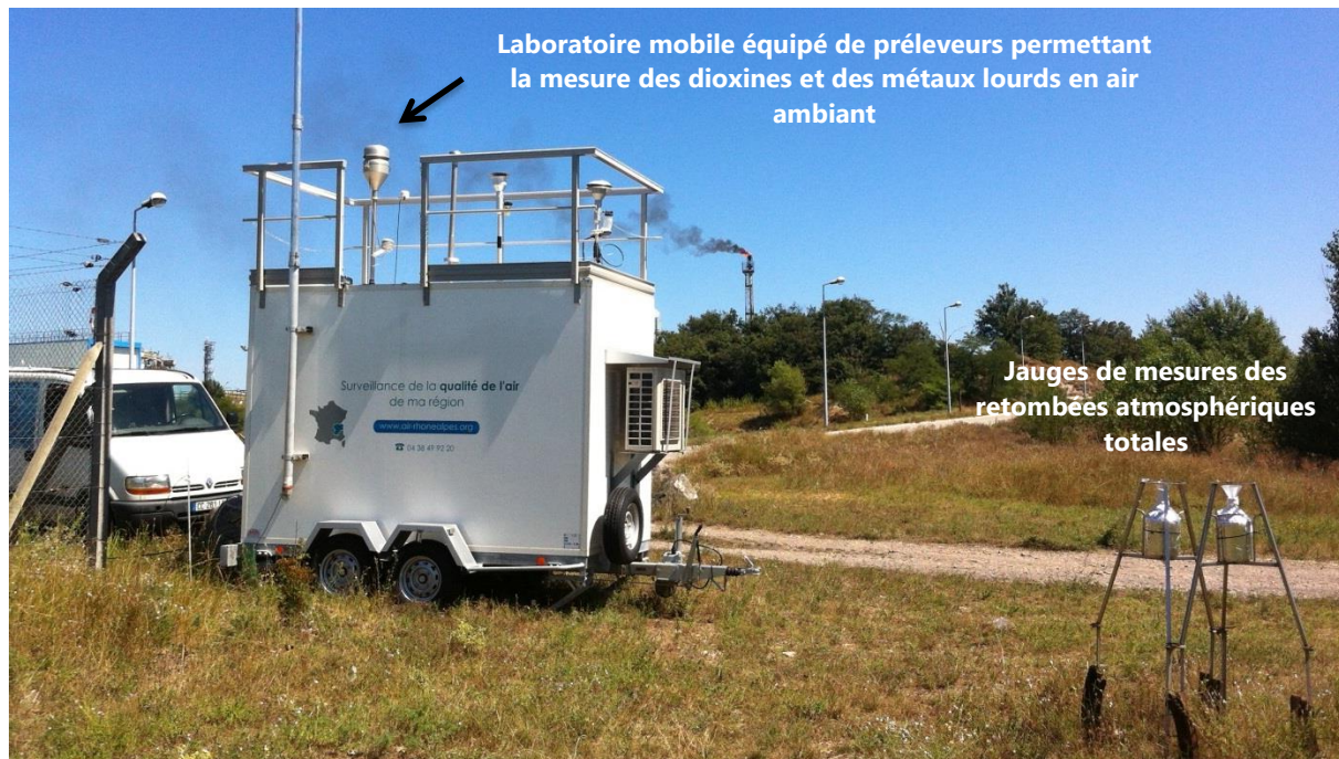
FIGURE 23 DISPOSITIF DE MESURES EN AIR AMBIANT ET DANS LES RETOMBÉES ATMOSPHÉRIQUES
