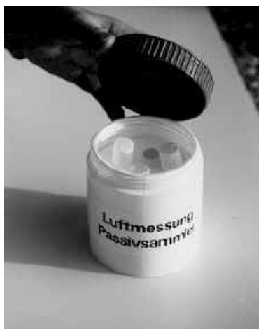
Figure 3 : dispositif de protection des tubes NO 2
