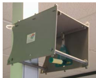
Figure 1.5.2.3 : Boîte de protection pour les tubes « Radiello »
