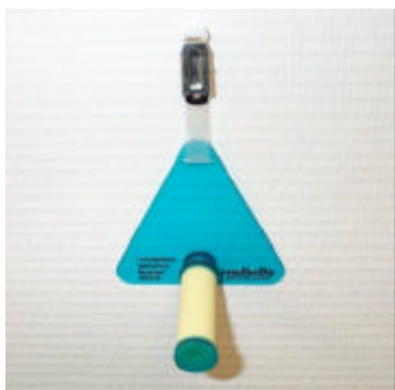
Figure 2.2 Photos des tubes à diffusion BTX (Radiello) : mesure du Benzène, du Toluène et des Xylènes
