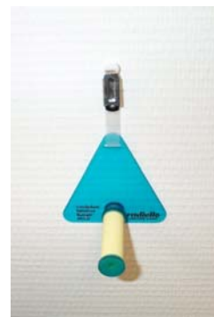
Figure 1.5.2.1 : capteurs passifs de mesure de benzène (Radiello)
