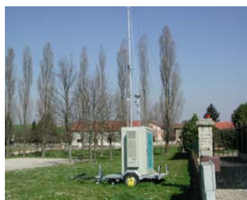
Figure 1.5.1.2 : remorque laboratoire équipée de son mât
