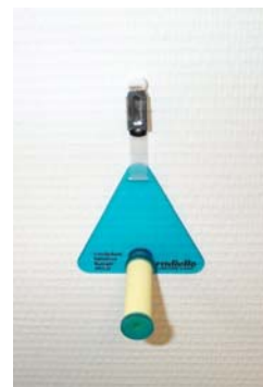
Figure 1.5.2.1 : capteurs passifs de mesure de benzène (Radiello)
