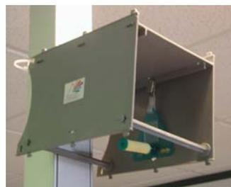
Figure 1.5.2.3 : Boîte de protection pour les tubes « Radiello »
