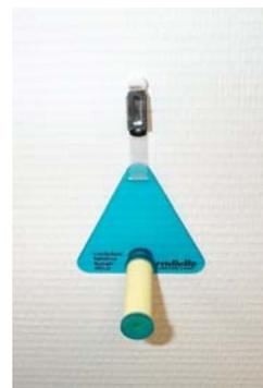
Figure 1.5.2.1 : capteurs passifs de mesure de benzène (Radiello)
