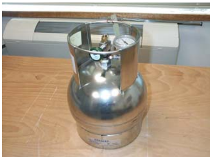
Prélèvement de COV par Canister
