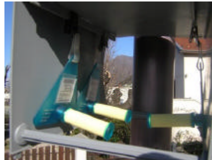
Figure 1.4 Photos des tubes à diffusion BTX (Radiello) : mesure du Benzène, du Toluène et des Xylènes
