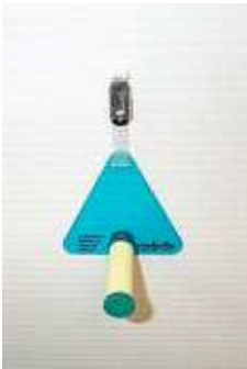
Figure 1.4 Photos des tubes à diffusion BTX (Radiello) : mesure du Benzène, du Toluène et des Xylènes
