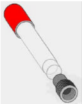
Figure 1.5 Photos des tubes à diffusion : mesure du NO 2
