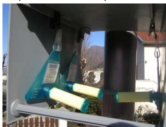
Figure 8 : Dispositif de mesure pour le benzène
