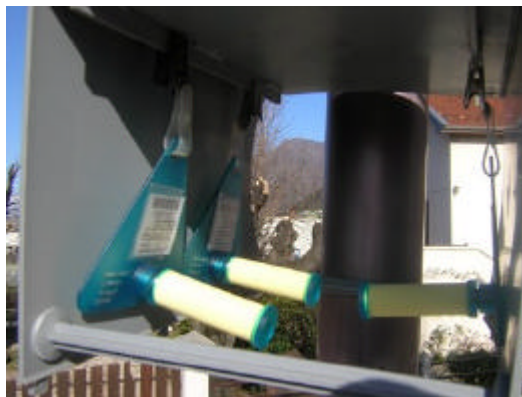
Figure 1.2 Photos des tubes à diffusion BTX (Radiello) : mesure du Benzène, du Toluène et des Xylènes
