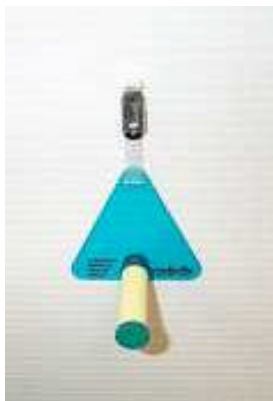
Figure 1.2 Photos des tubes à diffusion BTX (Radiello) : mesure du Benzène, du Toluène et des Xylènes
