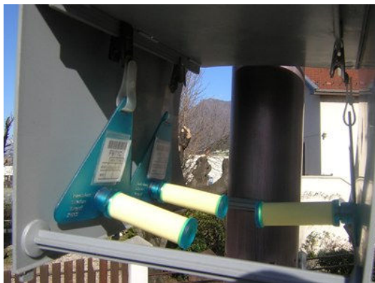
Mesure du Benzène, Toluène et Xylène par tube à diffusion (Radiello)
