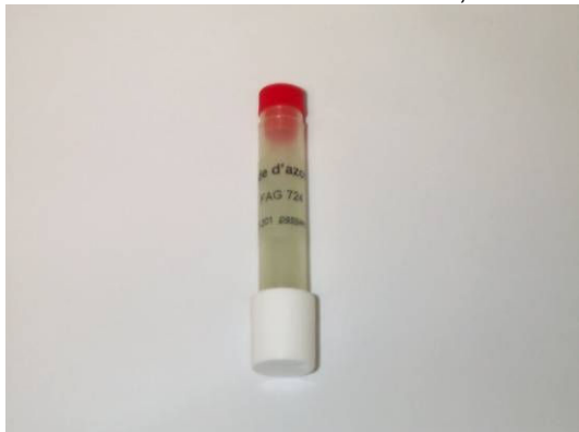
Mesure du dioxyde d'azote (NO 2 ) par tube à diffusion (Passam)
