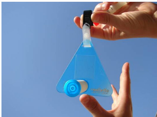
Mesure du Benzène, Toluène et Xylène par tube à diffusion (Radiello)
