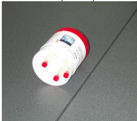
Mesure du dioxyde d'azote (NO 2 ) par tube à diffusion (Passam)
