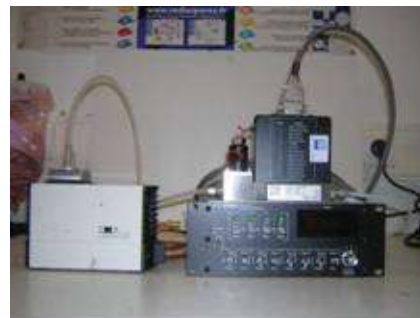
Prélèvement d'aldéhydes par cartouches DNPH
