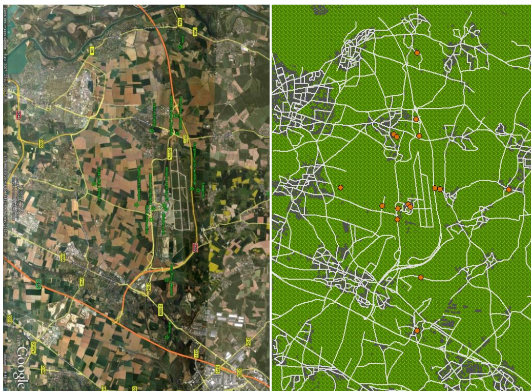
VUE SATELLITE DU DOMAINE D'ETUDE ET LOCALISATION DES SITES DE MESURES TEMPORAIRES (EN VERT). MAQUETTE GEOMETRIQUE DU DOMAINE D'ETUDE ET LOCALISATION DES RECEPTEURS (EN ORANGE).
