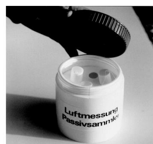
Echantillonneurs passifs NO 2 et NOx installés dans leur boîte de protection
