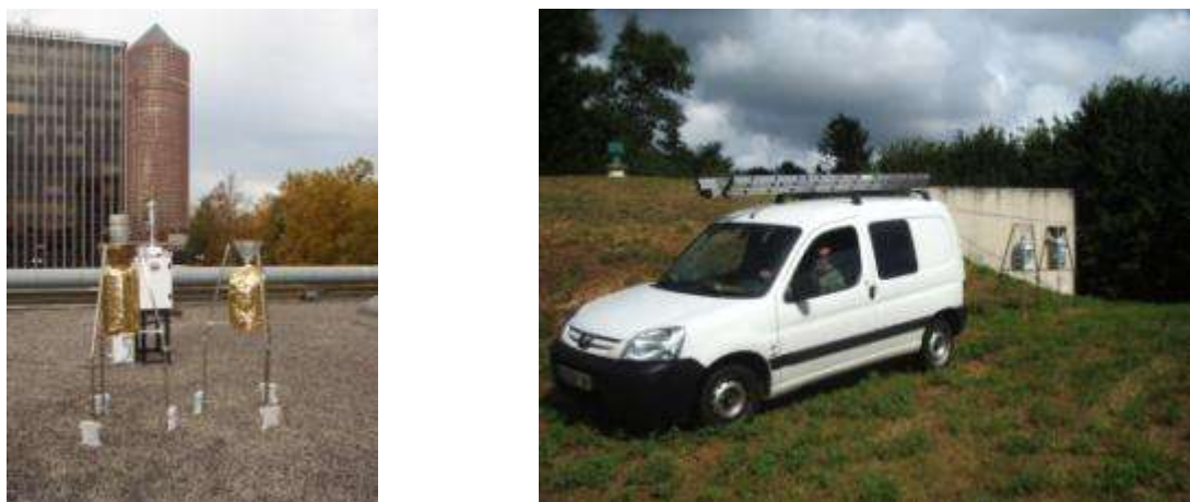
Figure 26 Jauges de mesures des retombées atmosphériques installées sur le site urbain de Lyon Centre (à gauche) et sur le site rural de Saint Germain aux Monts d'Or (à droite)
