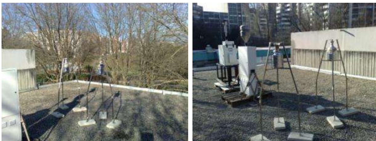
Figure 14 Jauges de mesures des retombées atmosphériques installées sur le toit de la station urbaine de fond « Grenoble les Frênes »
