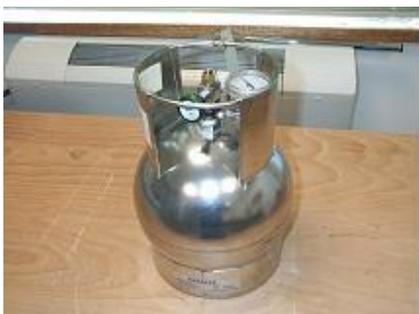
*Prélèvement de COV par Canister*
