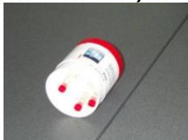
**Matériel utilisé pour les Tubes NO<sub>2</sub>**
