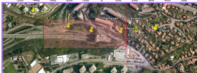
La bande d'impact correspond à la bande exposée à une concentration de  $\text{NO}_2$  supérieure à la valeur limite ( $40 \mu\text{g}\cdot\text{m}^{-3}$ )
