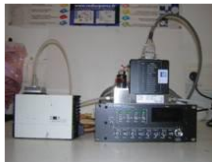
Prélèvement d'aldéhydes par cartouches DNPH
