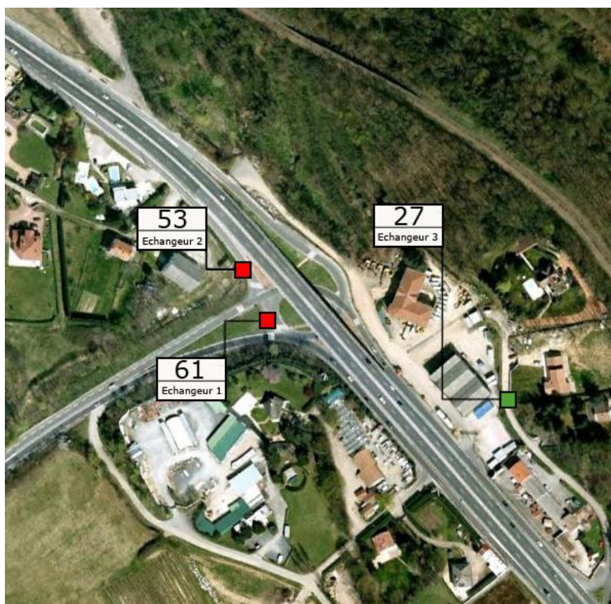
Figure 13 : Concentrations mesurées à proximité de l'échangeur N6-N89. Mesures par tubes à diffusion passive
