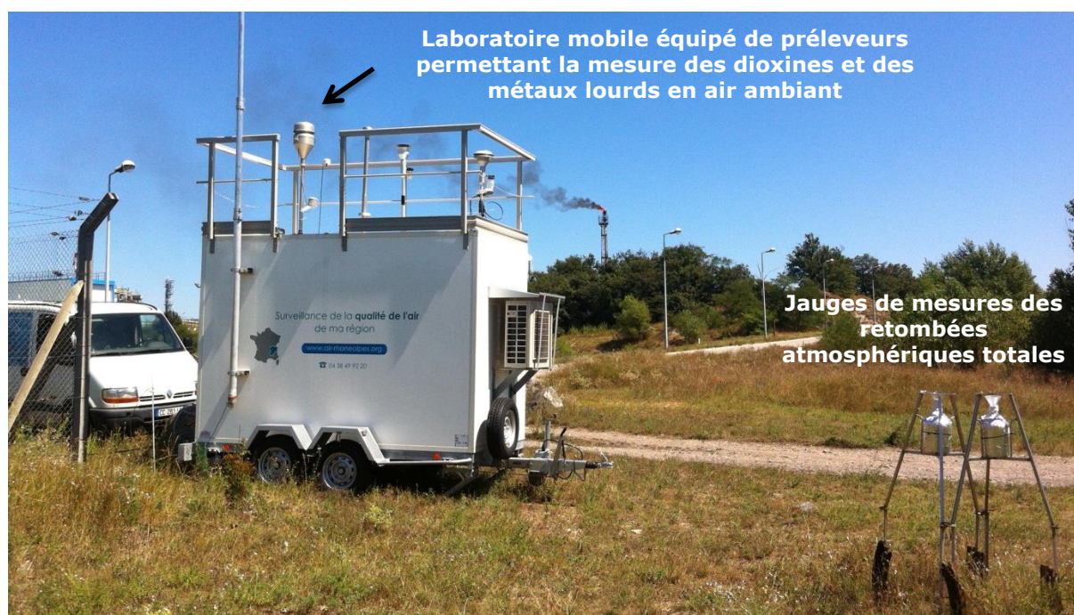
FIGURE 6 DISPOSITIF DE MESURES EN AIR AMBIANT ET DANS LES RETOMBÉES ATMOSPHÉRIQUES
