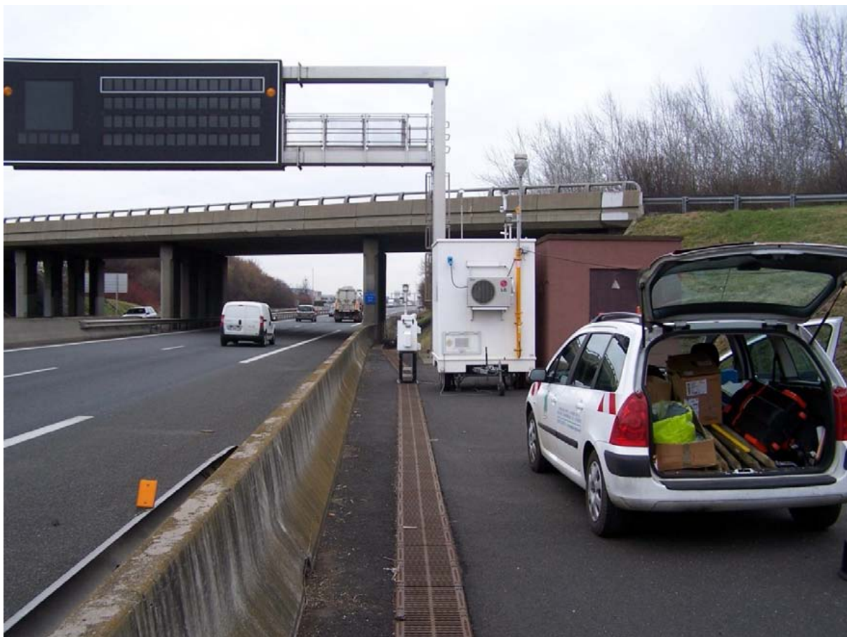
Implantation du laboratoire mobile et des préleveurs automatiques de métaux et de benzo[a]pyrène
