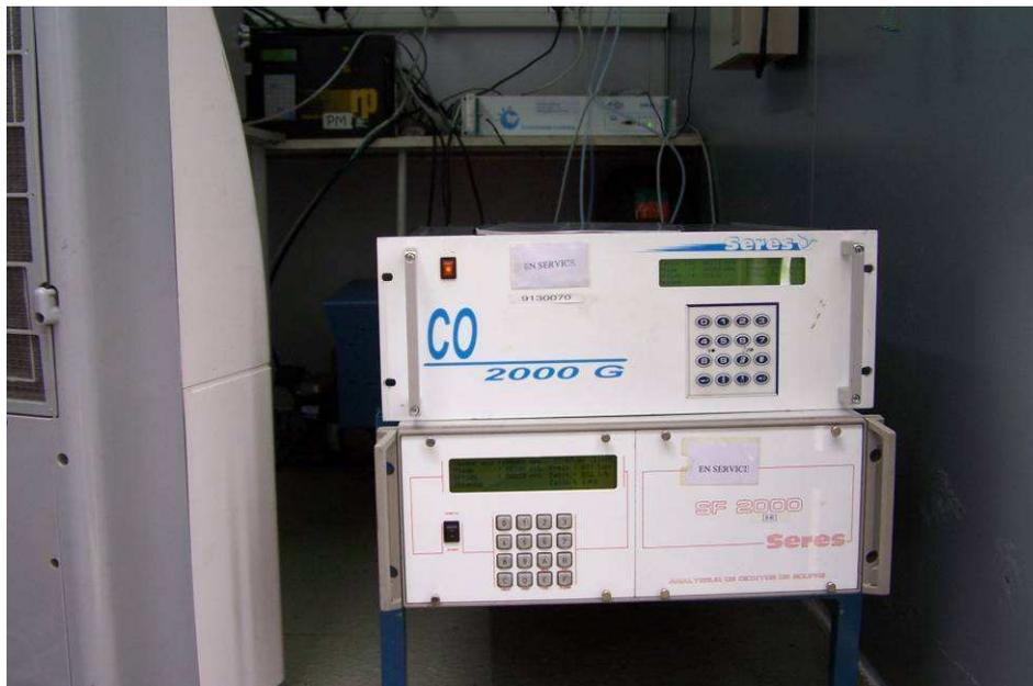
Analyseurs automatiques de monoxyde de carbone et de dioxyde de soufre à l'intérieur du moyen mobile
