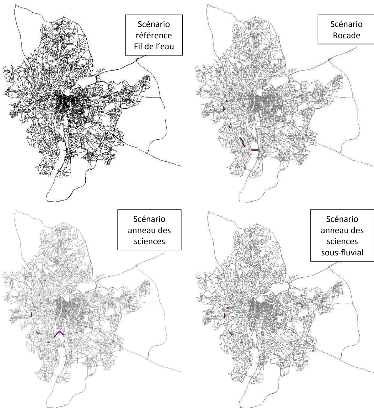
FIGURE 21 : RESEAUX SIRANE POUR LES DIFFERENTS SCENARI. LES BRINS EN VIOLET REPRESENTENT LES PARTIES AERIENNES DE LA NOUVELLE INFRASTRUCTURE.
