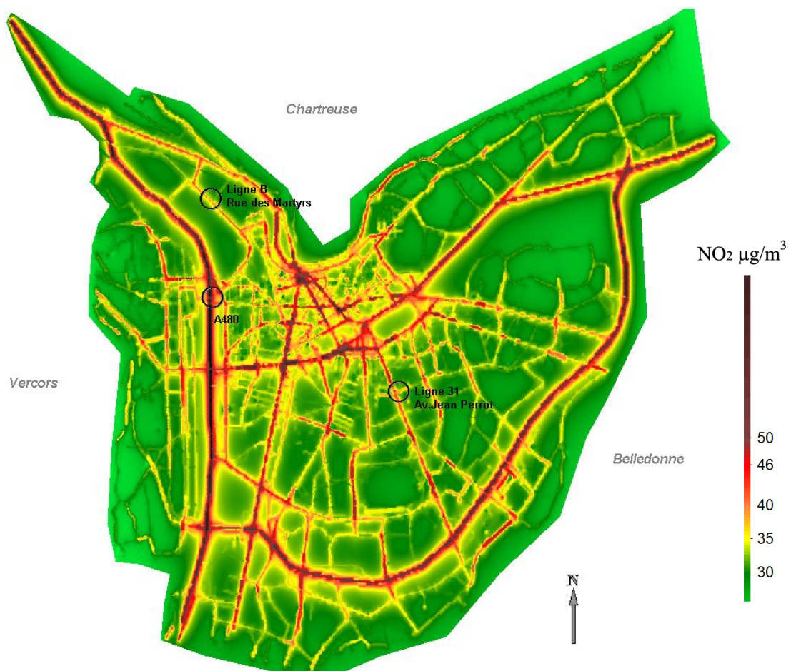
Cartographie de la concentration moyenne annuelle en dioxyde d'azote pour l'année 2007 sur le domaine SIRANE
