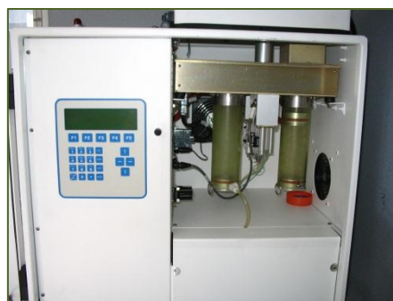
Figure 2 - PARTISOL PLUS - Vue intérieure (changeur de filtres)
