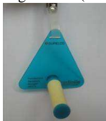
Figure 20 : préleveur Radiello pour les autres COV
