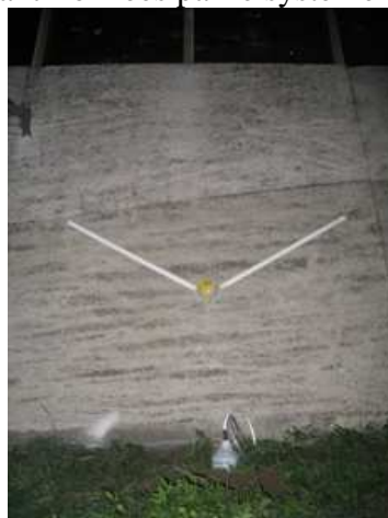
Figure 43 : système de collection des eaux de ruissellement.
