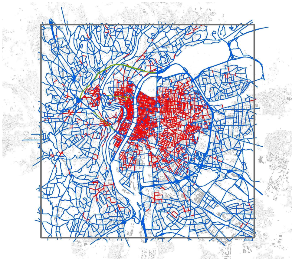
Figure 6 : Réseau de rues SIRANE, les brins bleus représentent les rues ouvertes, les brins rouges les rues canyons, et les brins verts les tunnels
