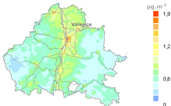
Cartographie des concentrations moyennes annuelles en benzène sur le territoire d'Atmo Drôme-Ardèche (2006).
