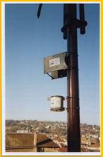
Prélèvements BTX par tube à diffusion
