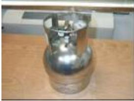
Les canisters d'une contenance de 5 litres sont au préalable mis sous vide. Lors de leur ouverture, ils aspirent l'air extérieur à travers une tête de prélèvement permettant de réguler le débit d'aspiration. L'aspiration cesse lorsque la pression à l'intérieur du canister est égale à la pression extérieure. Selon la tête de prélèvement, il est possible de remplir le canister soit en 8 heures, soit en 24 heures.
