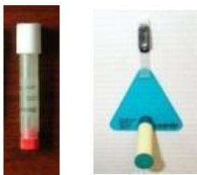
Figure 4: Tubes à diffusion passive (NO<sub>2</sub> et BTEX)
