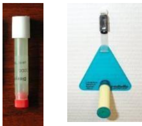
Figure 3: Tubes à diffusion passive (NO 2 et BTEX)
