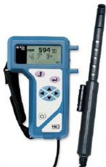
Figure 4: mesure du CO 2 et de la température.
