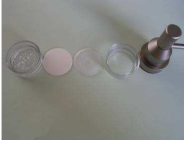
Ensemble des constituants de la tête de prélèvement
