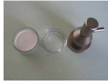
Positionner le filtre téflon (anneau en plastique sur le dessus)
