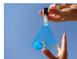
Figure 1 : Tube à diffusion passive.
