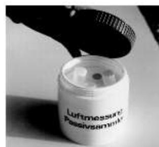
Echantillonneurs passifs NO<sub>2</sub> et NOx installés dans leur boîte de protection
