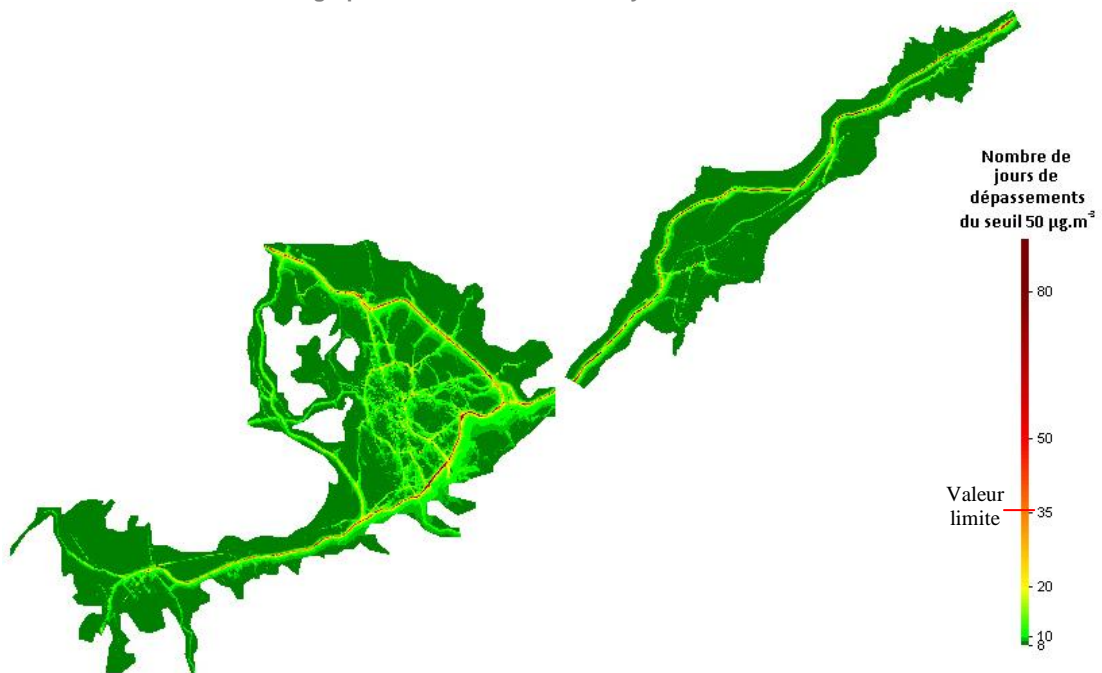
Cartographie du nombre de jours de dépassement du seuil 50 \mu\text{g.m}^{-3} en PM10.
