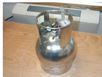
Figure 4 Canister pour le prélèvement des COV
