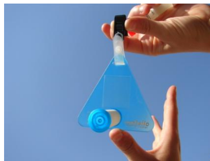
Figure 6 Tube à diffusion passive et son support
